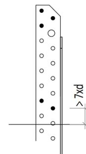
Es wird empfohlen, zur Reduzierung der Querkzugspannungen bei einer Teilausnagelung, 2 Nägel pro Schenkel mit einem Mindestabstand von  $7x d_n = 28\text{mm}$  zum Rand einzubringen und alle weiteren Nägel an den äußeren Enden anzuordnen.
